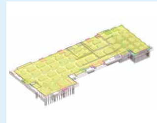
基礎・地盤改良の3Dモデル
